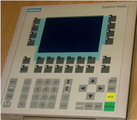
STR-C7-635 ist ein Kompaktgerät , wobei dann über MPI-Bus ein weiterer Ausbau mit weiteren Steuermodulen z.B. S7-313C möglich ist.
